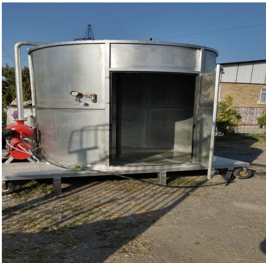
Рис.2. Общий вид парогенератора (Ферментатор-1) и внутренний вид бункера
